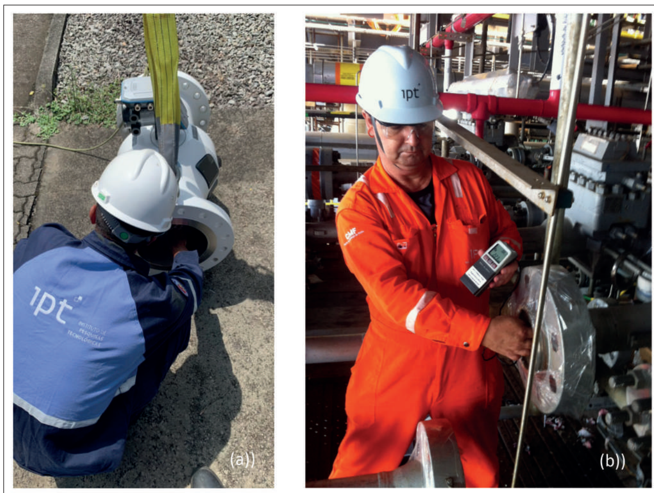
Figura 2. Imagens de inspeção metrológica dimensional em gás com: (a) medidor ultrassônico; (b) medidor tipo placa de orifício (acervo TRM/IPT).
